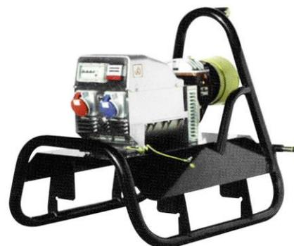
Ensemble mécanique sur châssis 3 points comprenant un alternateur accouplé à un multiplicateur de vitesse et un coffret électrique offrant 1 ou 2 prises TRI 400V, 1 prise MONO 230V pour TRI ou prises MONO uniquement Voltmètre, ampèremètre, fréquencemètre, compteur horaire, disjoncteur différentiel 0,03 A.
